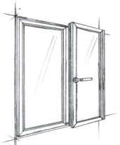
Ouvrant Soufflet Coulissant Parallèle (version AWS 75.II)
