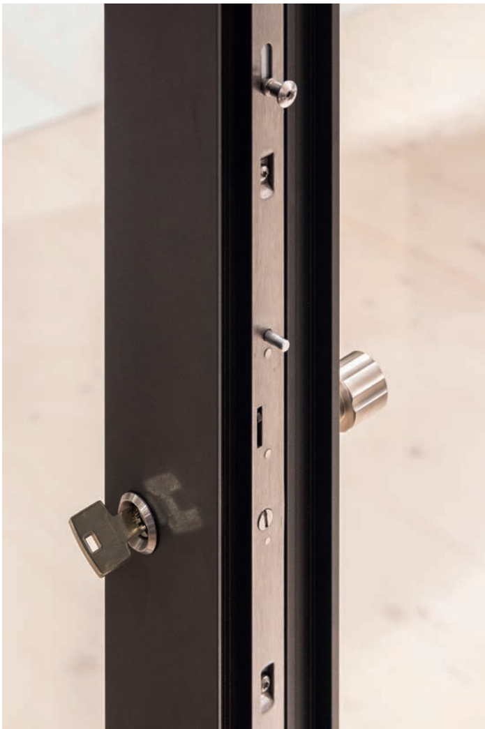
Vue extérieure : Percussion centrale 74 mm Serrure à galets 3 points Inox Déverrouillage extérieur par cylindre à clef.
